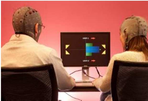
Figure 2.5.3.2 : Deux utilisateurs jouant à "BrainArena" en collaboration ou en compétition en imaginant des mouvements des mains pour marquer des buts
